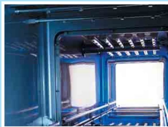
Waschzone ohne Innenleitungen.
