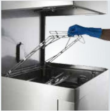
**Müheleise Reinigung des Innenraums:** ohne Demontage der Korb-Führungsschienen.
